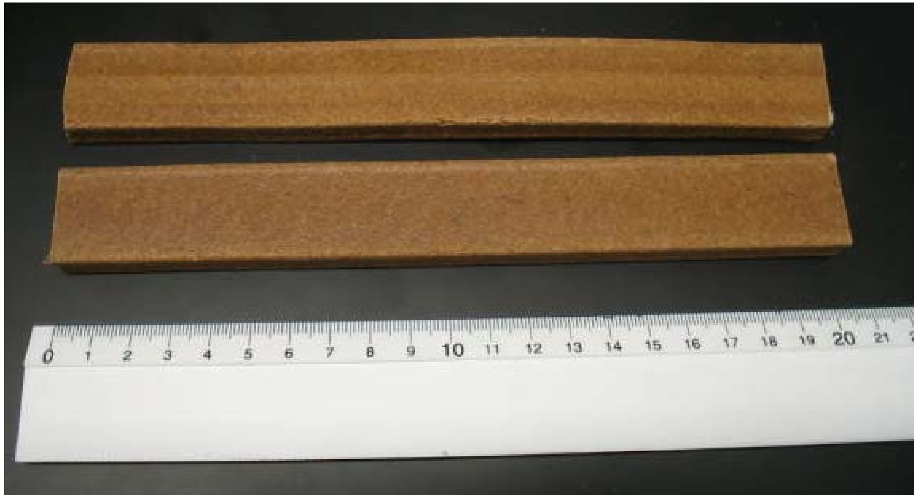
Perfiles Extruidos en equipo doble-tornillo cónico MSU
